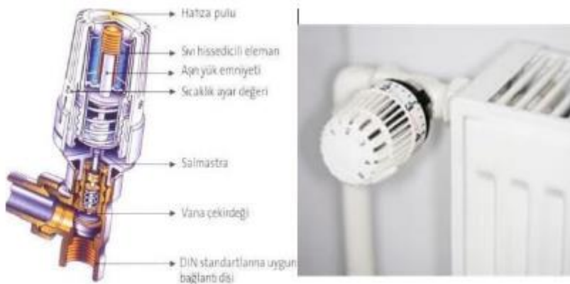
FOTOĞRAF 41: Radyatörlerde Termostatik Vana Uygulaması
